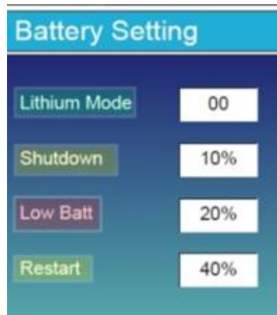
Rys.11. Ekran Battery Setting (źródło: Instrukcja Deye)
